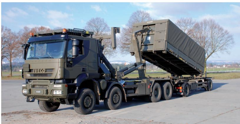
Autocarro 8x8, con sistema di carico e scarico di contenitori intercambiabili, e rimorchio a slitta per contenitori intercambiabili
