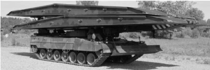
Brückenlegesystem mit Brückensatz 2×14 m
