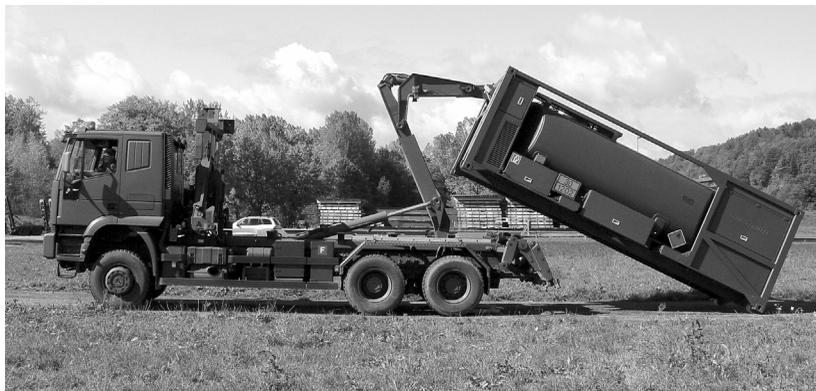
Scarico dall'autocarro Iveco 6×6
