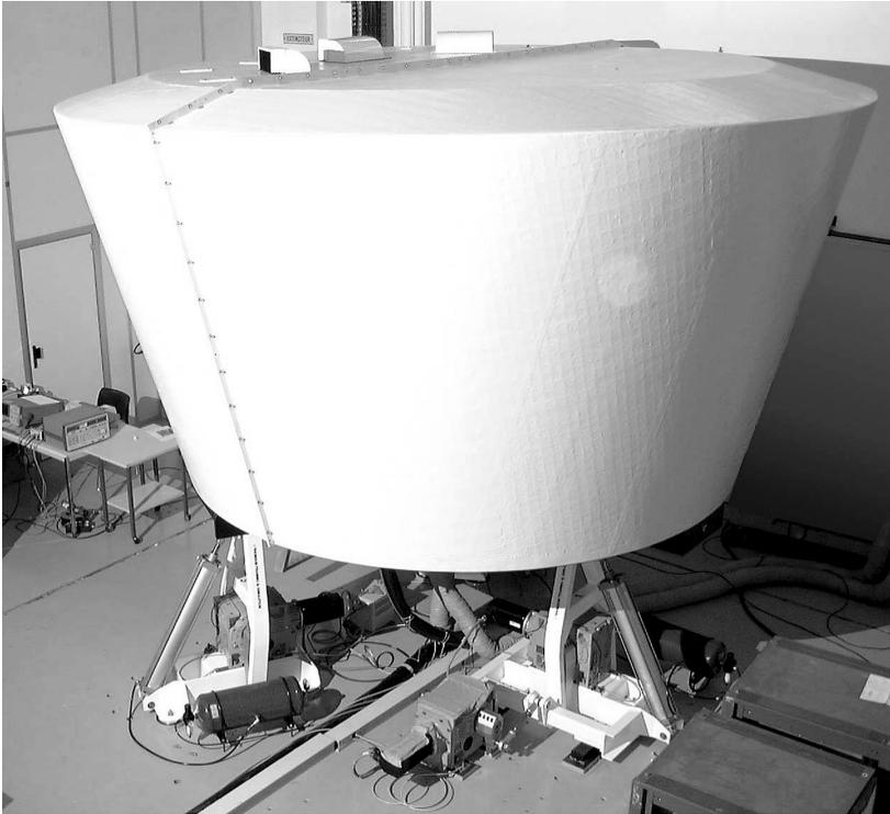
Aufbau des Prototyps einer Fahrerkabine
