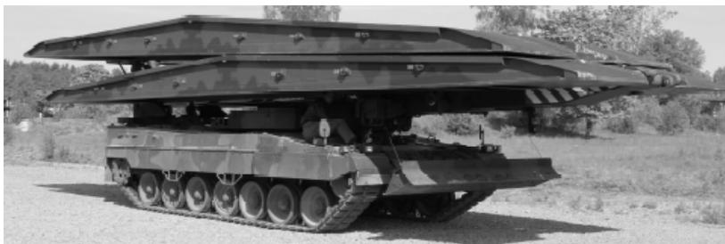
Système de pose de ponts avec jeu de pont de 2×14 m
