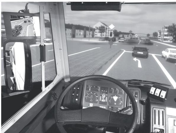
Réplique flexible de différents types de véhicules grâce à l'emploi d'un moniteur pour la représentation de l'instrumentation du tableau de bord
