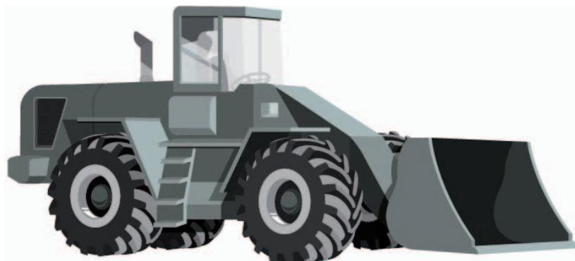
Chargeuse sur pneus 14 à 16t (illustration)
