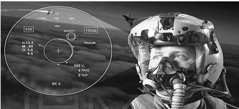
Le viseur intégré au casque permet au pilote de commander le missile au moyen de mouvements de tête.
