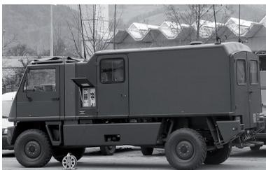
Véhicule de liaison SIC (4x4 DURO HT)
