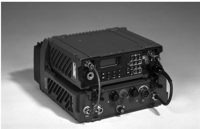
Il sistema radio HF SE-240 (livello di potenza 125 Watt)
