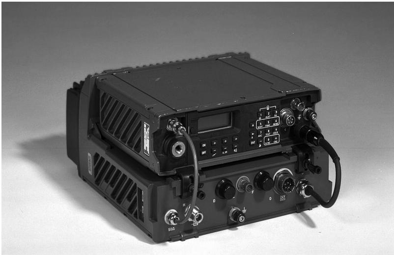
HF-Funksystem SE-240 (Leistungsstufe 125 Watt)
