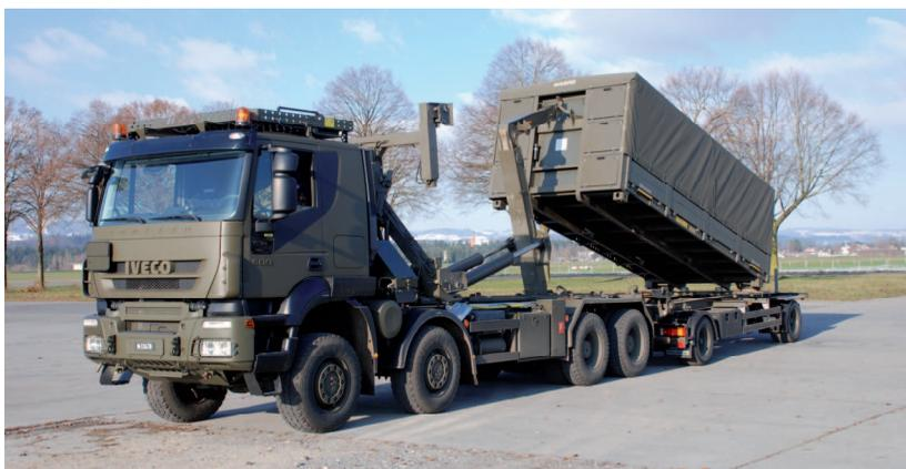
Lastwagen, 8x8, mit Wechselladesystem und Wechselaufbauanhänger mit Schlitten
